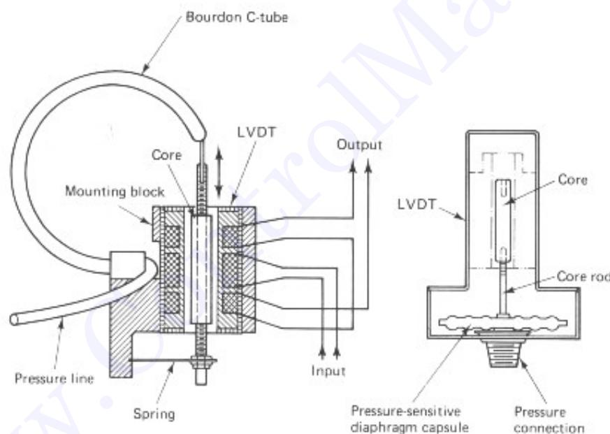
ترانسدیوسر فشار حسگر LVDT (a) یک تیوب بردن و (b) یک کپسول
