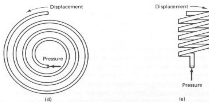
ترانسدیوسرهای فشار به جابجایی (a) کپسول (b) بادی (c) تیوب بردن ساده (d) مارپیچی (e) حلزونی
