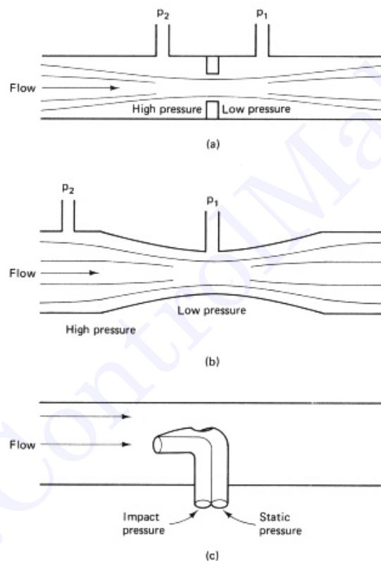
سنسورهای جریان با موانع فشار تفاضلی (a) صفحه سوراخ دار (b) venturi (c) تیوب Pitot
