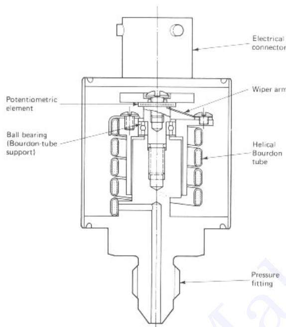
ترانسدیوسر فشار حسگر پتانسیومتر با یک تیوب بردن helical
