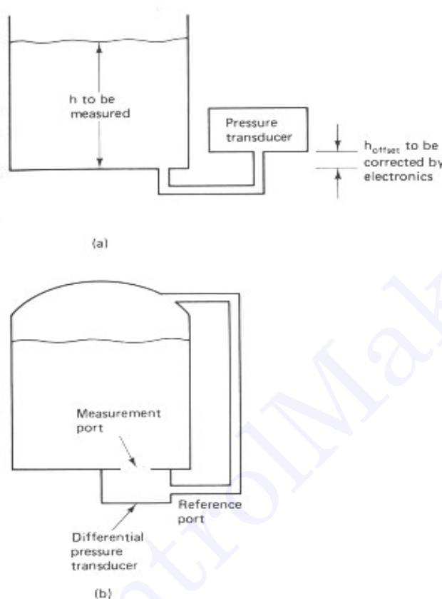
اندازه‌گیری سطح با حس کردن فشار با (a) یک ترانس迪وسر آفست و (b) یک مخزن درزگیری شده.
