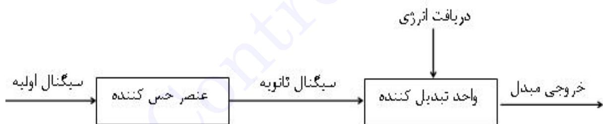
شکل 3 شکل شماتیک یک ترانسدیوسر (مبدل)
