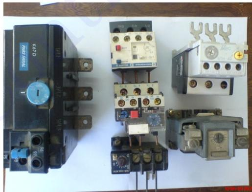
همان طور که در شکل زیر مشاهده می کنید در ساختمان داخلی آنها از دو فلز آهن و برنج که بر روی هم پرس شده و به صورت یکپارچه دیده می شوند استفاده شده است.
