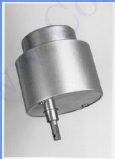
موتور هیسترزیس، موتور سنکرون بدون قطب‌های برجسته و بدون تحریک جریان مستقیم در رotor است و بنا به خاصیت تلفات هیسترزیس القایی ناشی از میدان گردان اولیه در ماده مغناطیسی هیسترزیس و در اثر پس‌ماند مغناطیسی ثانویه، بطور عادی و با سرعت سنکرون دوران می‌نماید. موتورهای هیسترزیس معمولاً در رنج قدرت خروجی کمتر از یک اسب بخار بکار گرفته می‌شوند.
