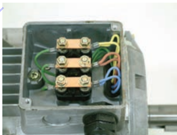
شکل ۱۴-۹- اتصال مثلث سیم پیچ های موتور
