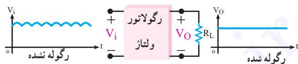
شکل ۸-۲-۲- بلوك دیاگرام رگولاتور ولتاژ و شکل موج های ورودی و خروجی آن درجه تثبیت ولتاژ خروجی  $V_o$  یا میزان تغییرات آن به سه عامل اساسی زیر بستگی دارد.
