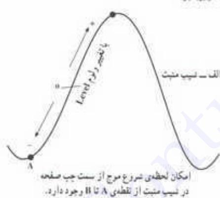
کلید - / Slope + : این کلید اگر از حالت + به حالت - درآید نیوب سیگنال ظاهر شده روی صفحه حساس معکوس می شود. (اگر اسیلوسکوپ دو کاتاله باشد نیوب سیگنال های ظاهر شده هر دو کاتال با هم معکوس می شوند). این کلید (Slope + / -) معمولاً همراه با ولوم کار می کند؛ بنابراین با کمک این کلید از هر نقطه‌ی شکل موج که بخواهی از سمت چپ صفحه‌ی حساس شروع شود امکان پذیر می باشد. شکل ۱۱-۴ امکان کنترل نقاط مختلف سیگنال را نشان می دهد.
