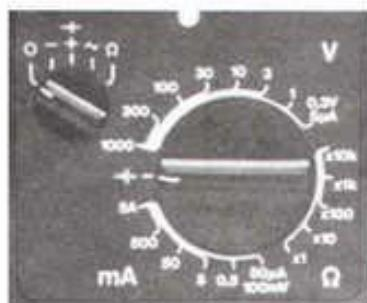
شکل ۳-۲- یک نمونه از کلید سلکتور اورومتر که علامت  $\parallel$ - را روی آن وجود دارد.
