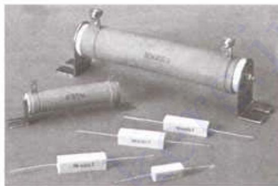
شکل ۶-۱-۲- نمونه هایی از مقاومت های بروزات ثابت
