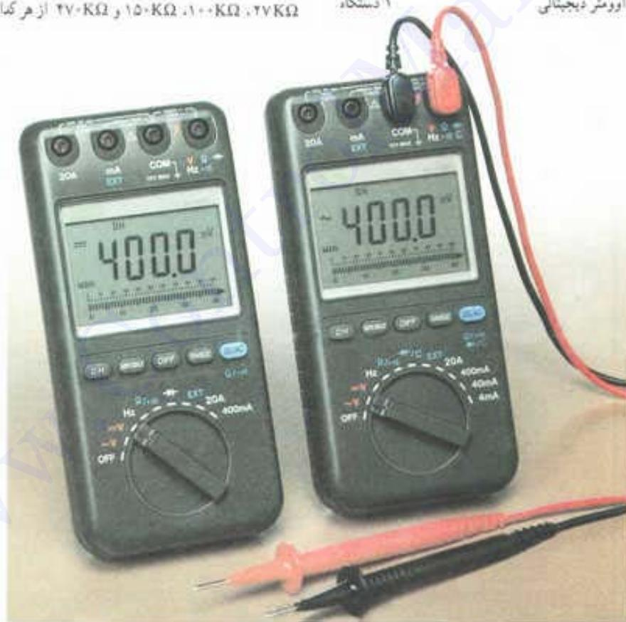
شکل ۳-۳- نمونه‌هایی از آوومترهای دیجیتالی
