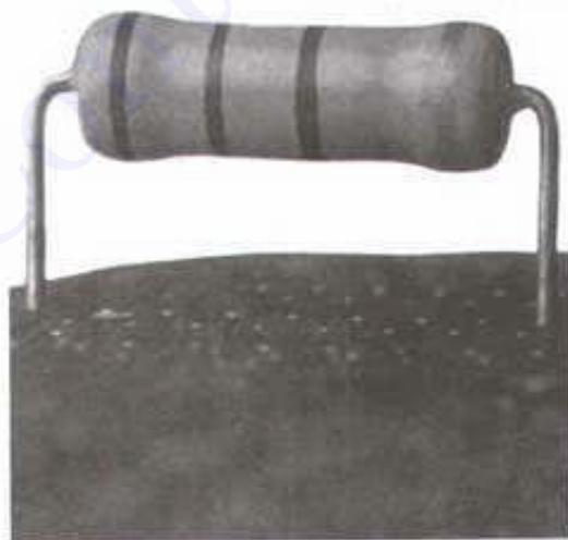
شکل ۲-۱- یک نمونه از مقاومت ثابت
