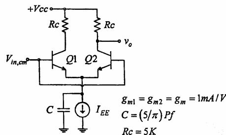
۵۷- برای مدار مقابل بهره ولتاز و مقاومت خروجی تقریباً برابر است با:  $g_{m1} = 2mV, r_{e1} = 5\Omega, h_{fe} = \beta = 100$
