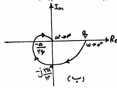
۶- سیستم کنترل حلقه بسته زیر را در نظر بگیرید که در آن تابع تبدیل سیستم حلقه بسته عبارتست از  $G(s) = \frac{s+1}{(s+1)(s+2)(s+3)}$ . برای این
