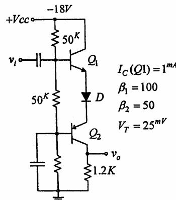
۵۲ - مقدار جریان  $I_o$  در مدار شکل رویه روبرو به کدام گزینه نزدیکتر است؟ ( $V_{BE} = 0.5V, \beta \rightarrow \infty$ )
