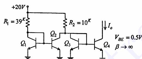
۵۳- منبع جریان در شکل زیر برای عملکرد صحیح حداقل به ۲ ولت ولتاژ بیاز دارد. ( $V_{min} = 2V$ )، حداکثر دامنه ولتاژ خروجی و جریان با پاس کلکتورهای  $Q_1$  و  $Q_2$  به ترتیب به کدام گزینه نزدیکتر است؟
