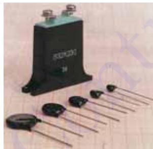
شکل ۱۶-۱ منحنی مقاومت - ولتاژ یک اریستور و نمای ظاهری چند اریستور مختلف
