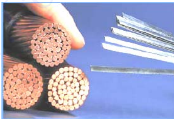
شکل (4-1): سیم های مسی در برابر نوارهای HTS
